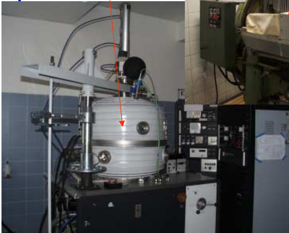
Vakuová napařovací aparatura
