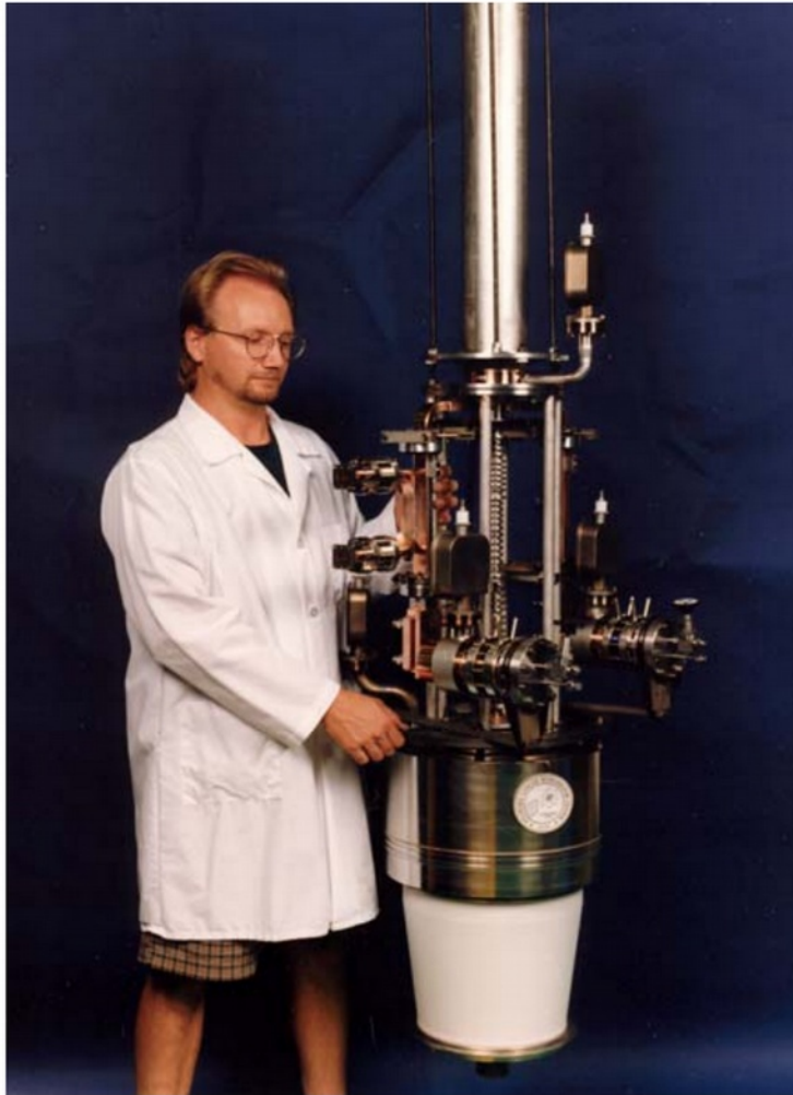
Fig. 19 The SLAC 11.4 GHz, 75-MW PPM klystron
