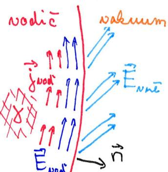
další detaily pro elektro. pole a proud uvnitř ohmick. vodiče
