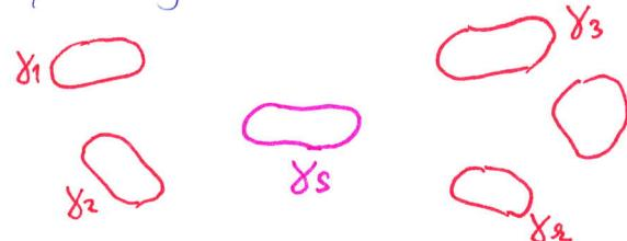
při pohybu smyčky  $\gamma_s$  se mění induktivnosti  $L_{ss}$  a  $L_{se}$
