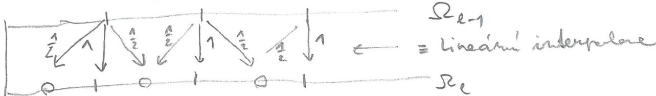
$$P_{e-1}^e = \begin{pmatrix} \frac{1}{2} & & & \\ 1 & & & \\ \frac{1}{2} & \frac{1}{2} & & \\ & 1 & & \\ \frac{1}{2} & \frac{1}{2} & & \\ & 1 & & \\ & & 1 & \end{pmatrix} \quad = \text{matice } N_e \times N_{e-1}$$
