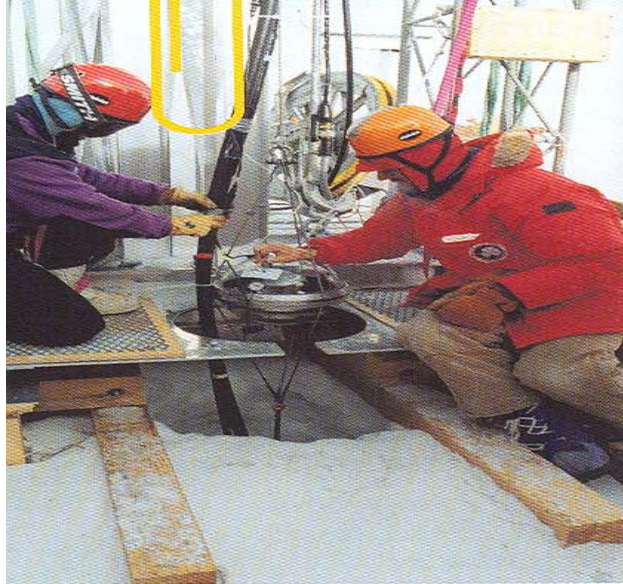
Arbeitsnehmer des AMANDA-Projekts im Präparieren einer Glaskugel
