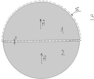
Ilustrace k bodům 1 - 3. Dva těsně přiléhající polokulové permanentní magnety se shodnou magnetizací. Pro účel výkladu k bodu 2 je též znázorněna velmi malá vzduchová mezera  $\delta$  mezi nimi.
