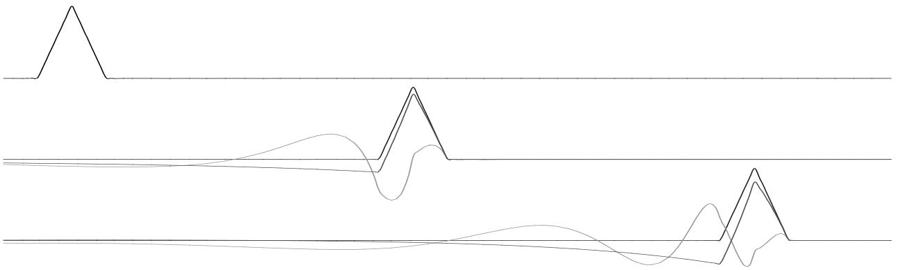
Obrázek 2: Šíření vlny v prostředí bez disperze a v prostředí s dvěma různě vysokými plazmovými frekven- cemi.
