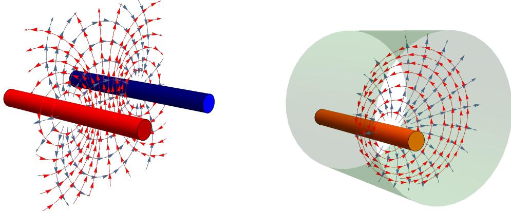
Obrázek 4: Dva rovnoběžné vodiče a jejich elektrické a magnetické pole. Siločáry obou polí leží u TEM vlny v rovině kolmé ke směru šíření vlny. Jeden z vodičů může obklopat ten druhý.
