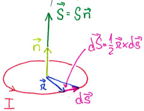
"bodový dipól" = limite malej polohy a většího proudu tak, že  $m = \lim_{S \rightarrow 0} IS = \text{const}$
