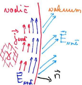
další detaily pro elektro. pole a proud uvnitř ohmick. vodiče
